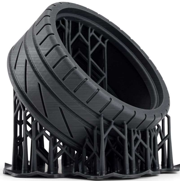
Slika 13. Primjer potpornih elemenata
